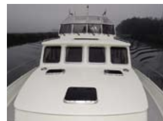
De overstekende rand van het dak van de opbouw is rond en dubbel afgewerkt om roestvorming te voorkomen.
